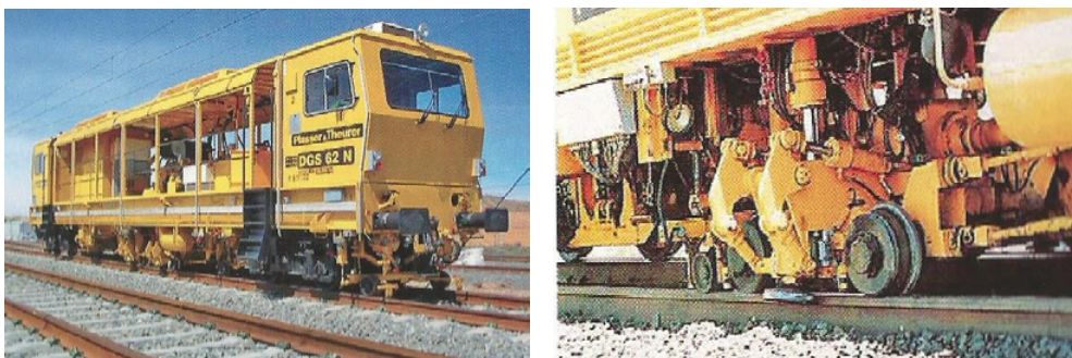
Slika 1. i 2. Stroj za strojno reguliranje (dinamičko stabiliziranje) kolosijeka
