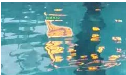
Slika 16. a) lažna detekcija čamca (Mask R-CNN) b) lažna detekcija osobe (YOLOv3)
